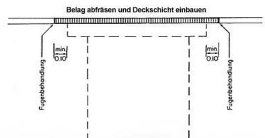
Für die Grabenauffüllung kann je nach Schutzzone nach Absprache mit dem Betriebsleiter des Unterhaltsbezirks auch Gemisch RCB 0/45 OC 85 verwendet werden.
